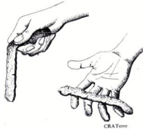
الشكل رقم 05: اختبار عجينة الطوب CRATerre, Op cit, p. 181
